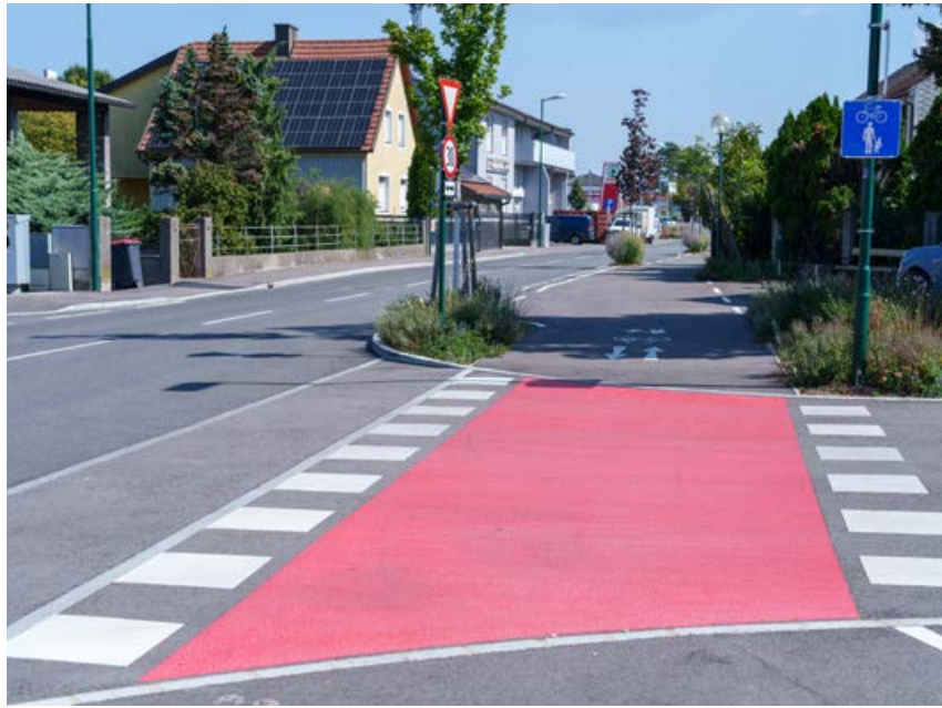
Radfahrerüberfahrt im Zuge eines Radweges
