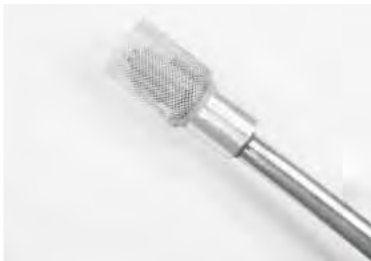
Sensorsystem für die Ölzustandsüberwachung durch die Messung von Viskosität, Leitfähigkeit, Permittivität, Korrosivität und Öltemperatur
